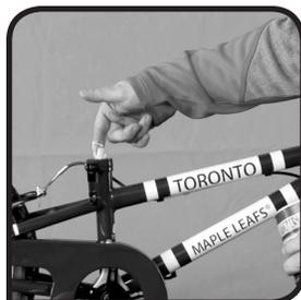
Fig. 2 Lubrifier le tube de direction
